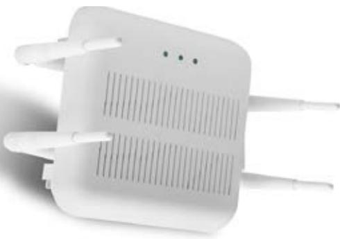
Der bintec W2003n-ext kann als eigenständiger Access Point agieren oder als WLAN Controller (Master Access Point) bis zu sechs weitere Access Points managen.
